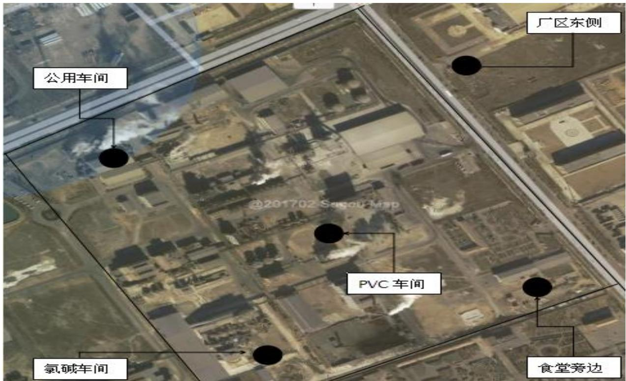
根据《地下水环境监测技术规范 (HJ 164-2020)》规定，布设地下水监测点位：1#井；2#井；3#井；4#井；地下水监测井位置如下图：
